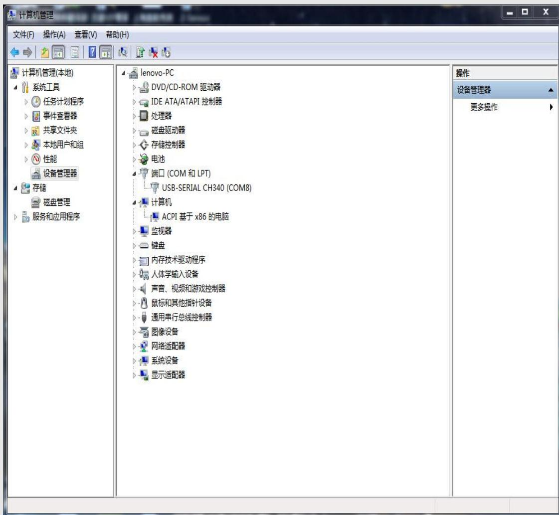
打开串口调试助手。端口选择上一步查到的端口号。波特率、数据位、停止位、有无奇偶校验等按照通讯协议里选择并打开串口。在发送区输入通讯协议里的通讯命令，点 HEX 显示，再点击手动发送即可实现传感器的通讯工作。
