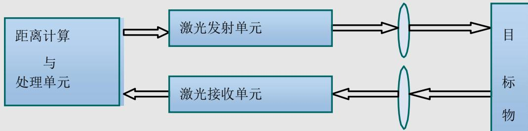
脉冲激光测距系统原理框图
