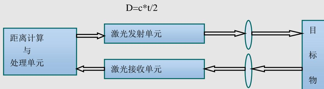
脉冲激光测距系统原理框图
